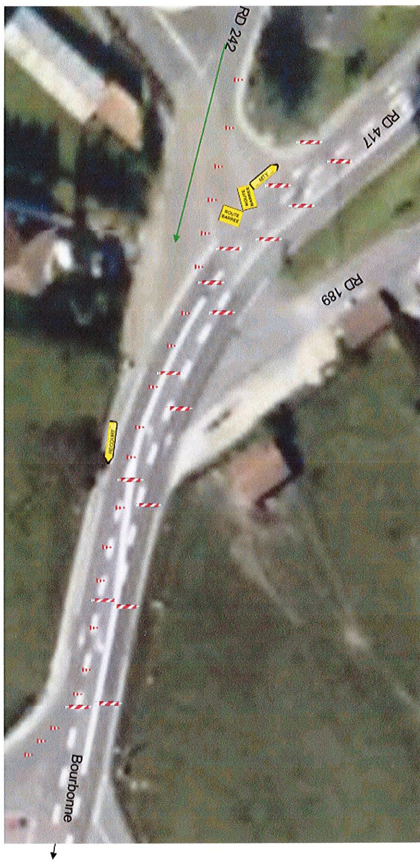
Implantation des balises qui délimitent les voies de circulations.
