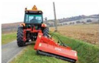
**2 Ensemble avec bras de fauchage ou débroussaillage**
